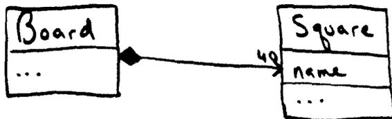
图17-5 在设计模型的DCD中，Board与Square具有组成聚合关联。我们在静态模型中应用了创建者
